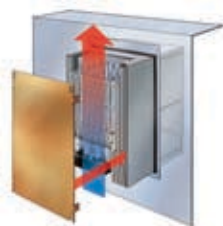
Dissipatore attraverso il quadro.
