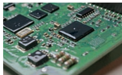
Schede di controllo con rivestimento superficiale per ambienti aggressivi.
